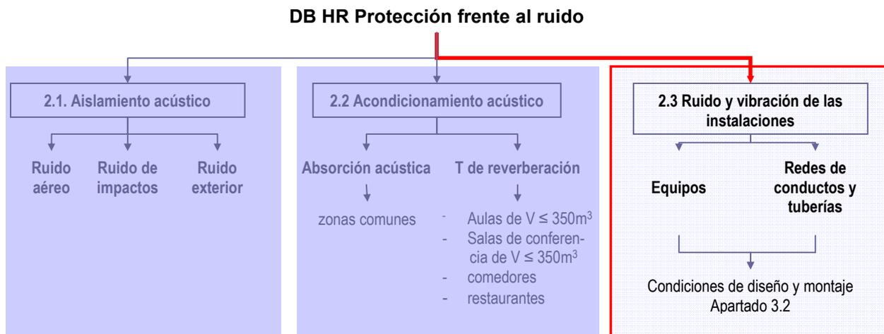
Las instalaciones de un edificio constituyen un conjunto heterogéneo de dispositivos que pueden influir en el confort acústico, ya sea porque deterioran los elementos constructivos a los que se anclan o porque generan ruidos y vibraciones que se transmiten a los recintos del edificio. En este sentido, el objetivo del DB HR es:
